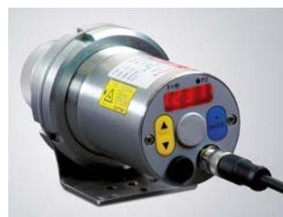
CellaCast PA 80のもう一つの照準オプションとして、レーザースポットライトが搭載されています。レーザードットはターゲットスポットの中心を示し、最大10m離れていてもよく見えます。レーザーは押しボタンで直接作動させるか、外部スイッチやインターフェースを使ってリモートで作動させることができます。
