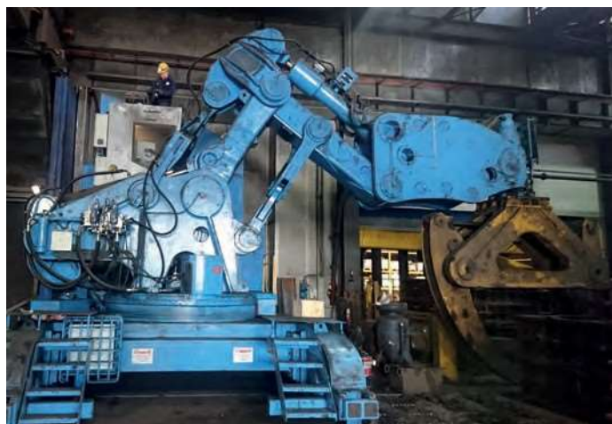
最大処理能力20トンの C20020 レール式マニピュレータ
