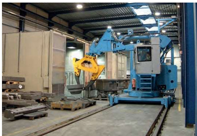
最大処理能力5トンの C5010 レール式マニピュレータ
